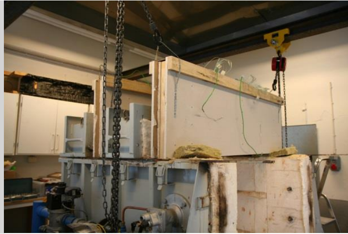
Figur 5. Provelementen placeras över ugnen och brandexponeras underifrån.
